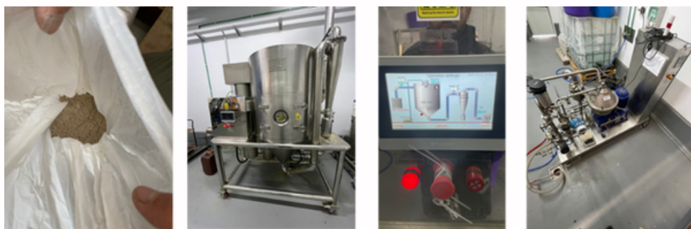
Figura 5. Uso de Spray Drying para la transformación de materia bacteriana en polvo.
